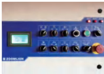
电机泵控制面板 Motor Pump Control Panel
