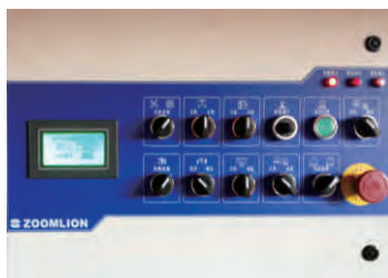
电机泵控制面板 Motor Pump Control Panel
